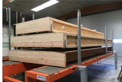
**Toitures sur-isolées et végétalisées, réalisées en caissons préfabriqués**
