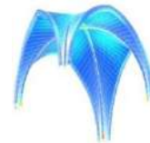
Simulation numérique d'une voûte à croisée d'ogive
