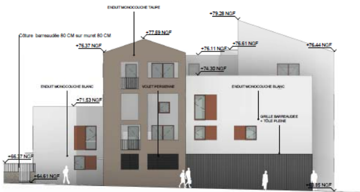
3 Élévation Bât C, D OUEST 1 : 200
