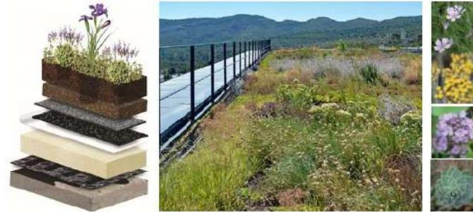
Exemple de toiture végétalisée extensive avec végétation variée (sédums, vivaces, sous-arbrisseaux)
