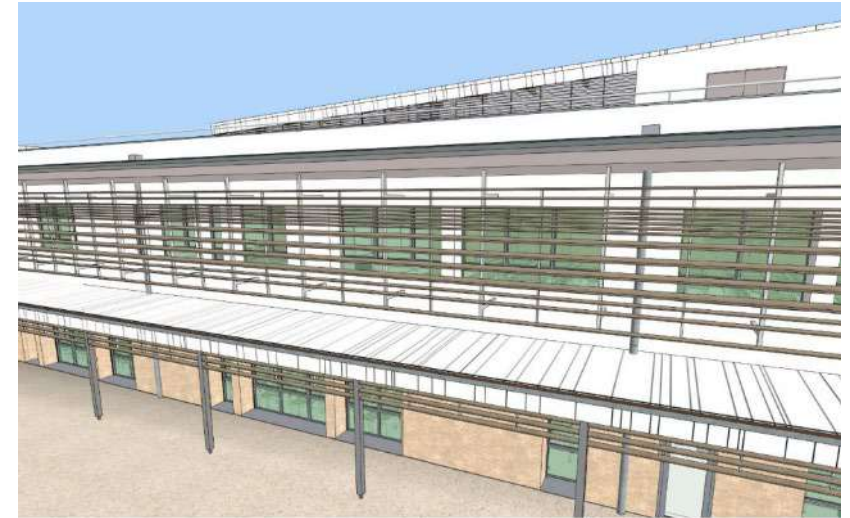
Figure 12 : Brises soleil façade Ouest
