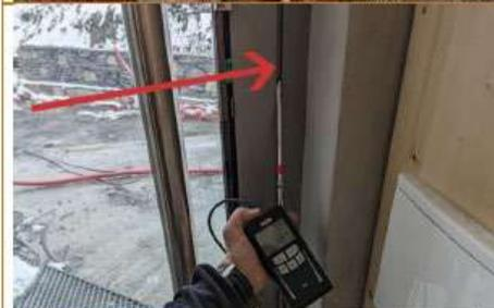
Type : C4-Porte palière ou porte coupe-feu: Mauvaise compression des joints de portes (hors barre de seuil)
