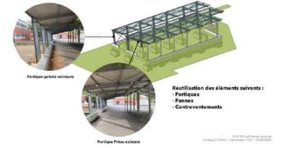
Réemploi des portiques de la galerie pour le local vélo
