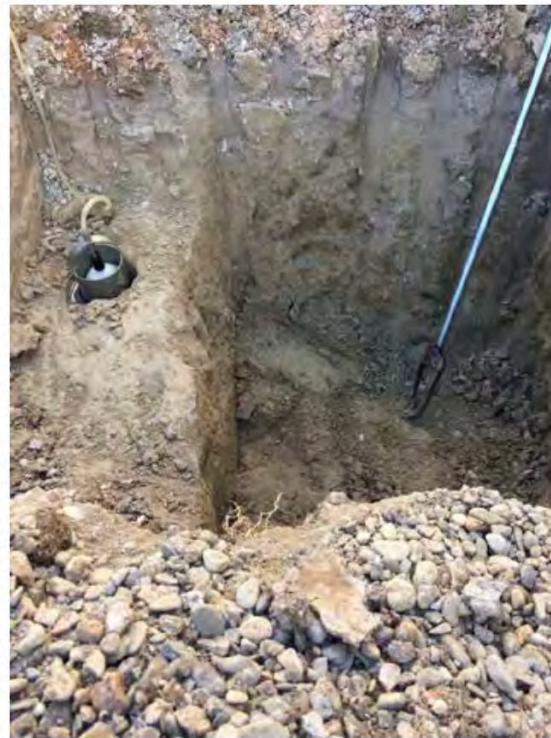
Analyse des horizons, de la structure du sol et de sa capacité de rétention en eau et par la même la réserve en eau du sol qui pourra être mobilisable par les végétaux plantés
