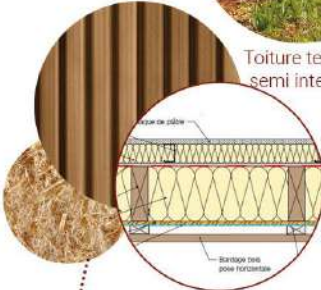
Mur ossature bois + Bardage bois pour le pavillon CDI
