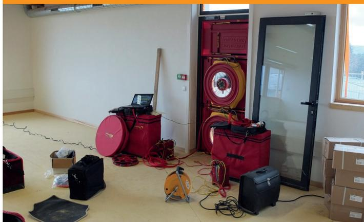
Deux tests d'étanchéité intermédiaires ont été réalisés.
