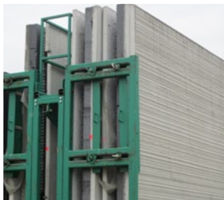
Les murs à coffrage et isolation intégrés préfabriqués - Photo © ADEME
