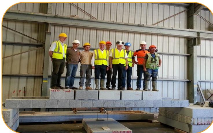
*Tests d'une poutre précontrainte « plancher/plafond » en granit du Sidobre
