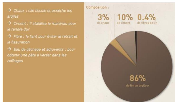
Sur le chantier : CEMATerre (limon argileux) + ciment+chaux+fibrés malaxés, associés à un procédé de mise en place par vibration innovation mondiale (brevet) → chaîne de production mobile
