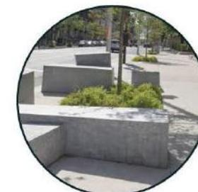
Des banquettes de pierre permettent d'éviter les intrusions sur les délaissés
